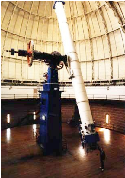
Figura 5. Dos telescopios profesionales de tipos distintos. A la izquierda el telescopio refractor más grande del mundo (observatorio Yerkes en Chicago, EU). Su objetivo es una lente de 1,2 metros de diámetro. A la derecha el que fuera por más de 40 años el telescopio más grande del mundo (telescopio Hale en Monte Palomar, California, EU). Su objetivo es un espejo monolítico de 5,2 metros de diámetro.
