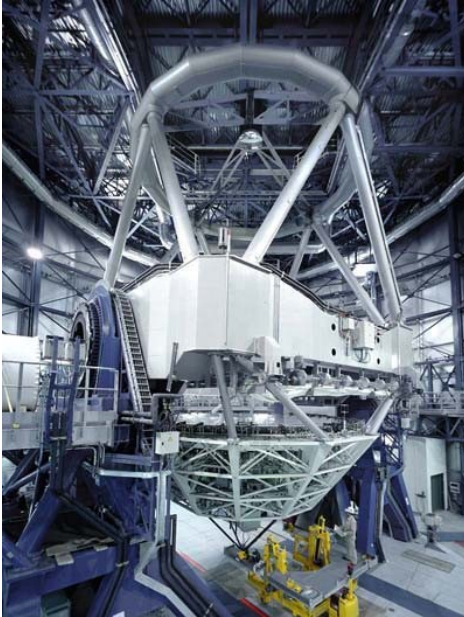
Figura 9. Los dos tipos diferentes de monturas. La montura altacimutal de uno de los telescopios del VLT (izquierda). La enorme montura ecuatorial del gran telescopio Hale (derecha).
