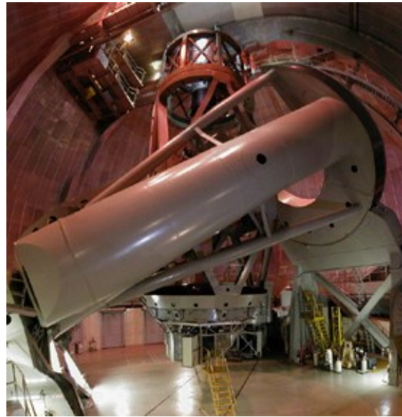
Figura 9. Los dos tipos diferentes de monturas. La montura altacimutal de uno de los telescopios del VLT (izquierda). La enorme montura ecuatorial del gran telescopio Hale (derecha).
