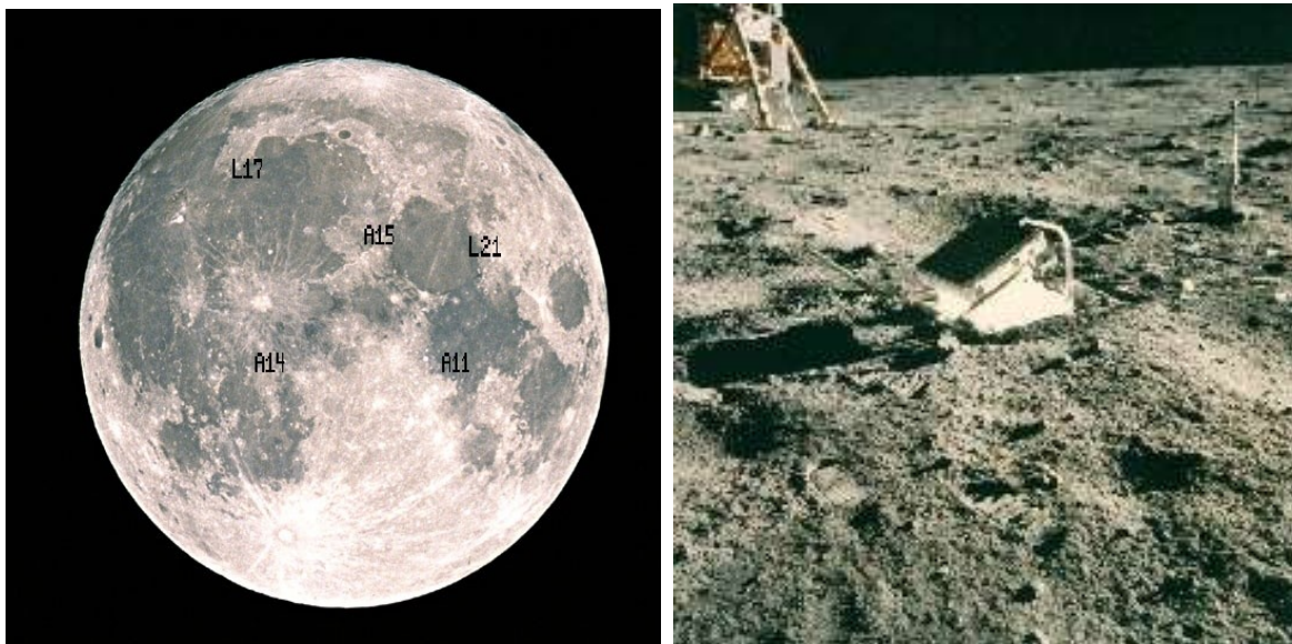
Figura 33. A la izquierda la ubicación en la Luna de los puntos de alunizaje de las misiones americana Apolo (A11, A15, etc.) y rusas Lunik (L17, L22). A la derecha uno de los sistemas de espejos colocados por las misiones Apolo para las medidas precisas de la distancia usando ecos de luz visible. Los espejos están directamente dirigidos hacia la Tierra.
